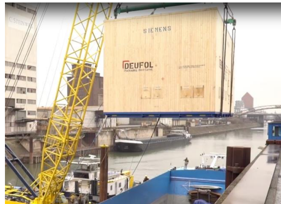
Bild: Verladung einer Siemens-Kiste, konstruiert und verpackt von Deufol mit knapp 300 to. Gewicht. (Foto: Deufol)
